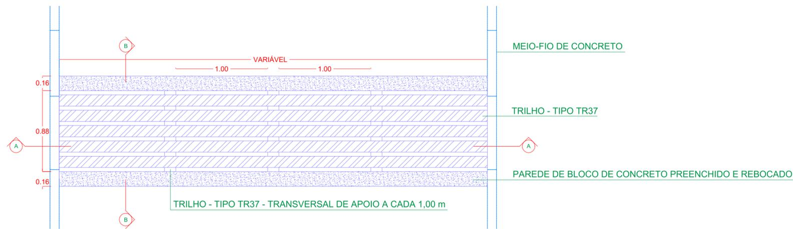
DETALHE - PLANTA BAIXA - TRINCHEIRA
