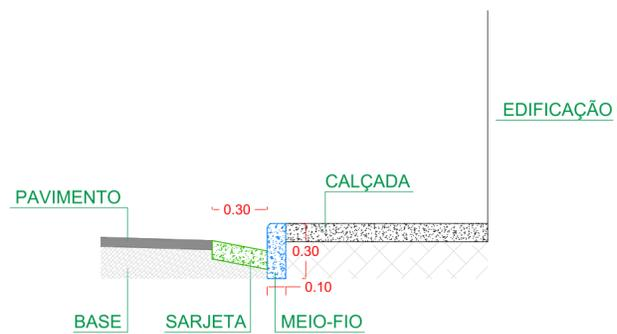
DETALHE - CORTE - SARJETA E MEIO-FIO
